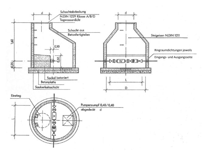
Im Grundwasser stehende Schächte sind wasserdicht auszuführen! Gegebenenfalls ist vor Auftrieb zu sichern.
